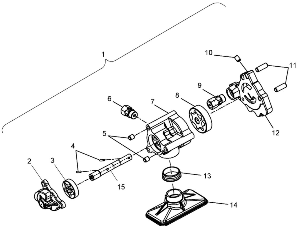
СПИСОК ДЕТАЛЕЙ ДЛЯ "ENGINE OIL PUMP ASM. -
